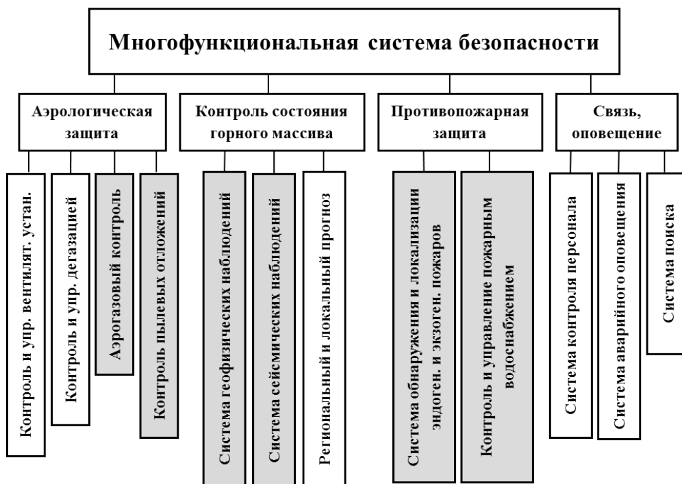
Рис. 1. Функциональная схема системы безопасности
