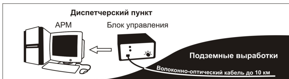
Рис. 2. Архитектура подсистемы мониторинга
