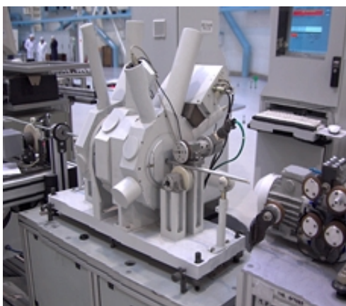
Рис. 1. Оптико-электронная система РАЗМЕР-06 для бесконтактного контроля геометрии ТВЭЛ
