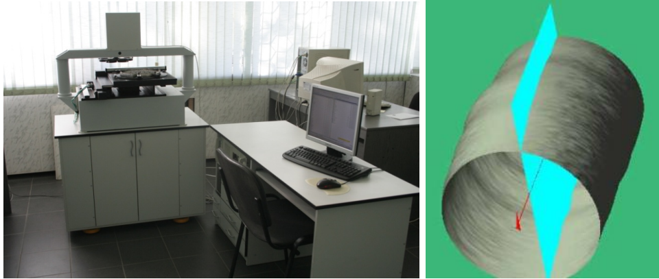
Рис. 3. Универсальная лазерная измерительная система РЕШЕТКА-Н для контроля геометрии дистанционирующих решёток российского и западного дизайна (слева) и 3D модель измеряемой ячейки (справа)
