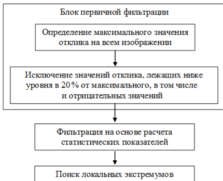
Рис. 1. Схема предложенного алгоритма фильтрации кандидатов
