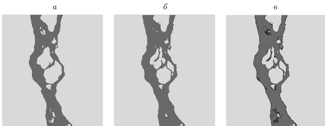
Рис. 3. Определение изменения площади песчаных наносов (осередков). Результат обработки данных Sentinel-1, к полученным снимкам применен алгоритм кластеризации K-means
