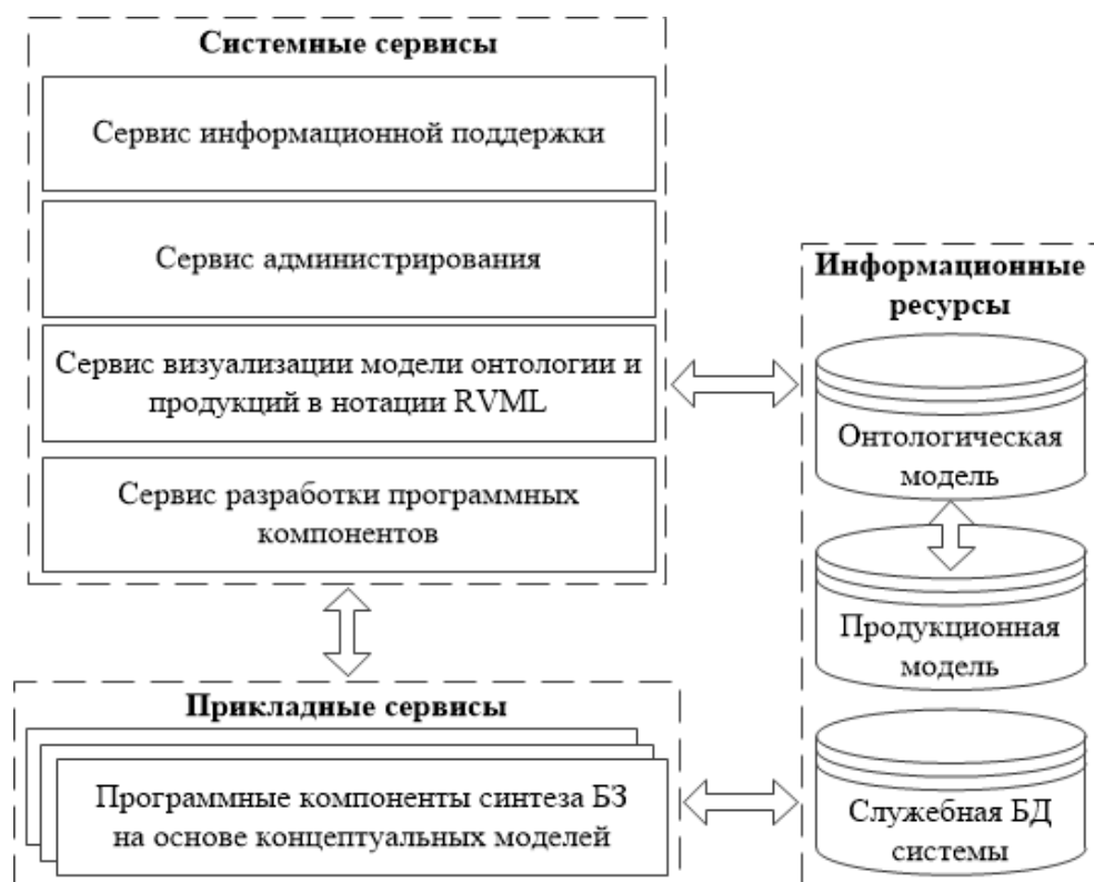
Рис. 3. Концептуальная архитектура сервис-ориентированной системы
