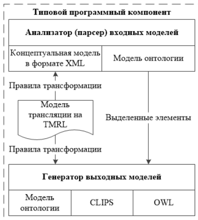
Рис. 4. Архитектура типового программного компонента
