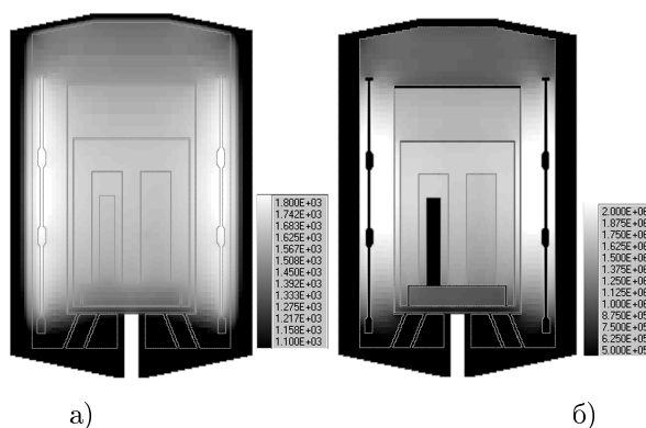
Рисунок 10. Теплообмен в вакуумной электропечи сопротивления (сетка 5 \cdot 10^6 ячеек): а) поле температур, К; б) поле плотности потока излучения, \text{Вт/м}^2 .
