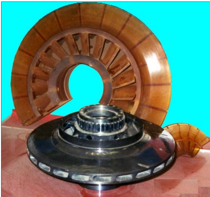
Рис. 2. Рабочее колесо насоса и его модель для исследования НДС
